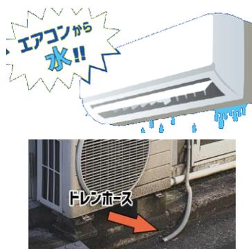
エアコンは温かい空気を取り込み、冷気に変えて室内に送り込みます。このとき温かい空気が急に冷やされることで、結露が発生します。通常その水はドレンホースを通して、外に排水される仕組みです。(ドレンホースとは室外機の近くにある、蛇腹のホースのこと)しかし、ドレンホースが詰まるなどして排水がうまくできなくなると、行き場をなくした水滴が、室内機から漏れてきます。
